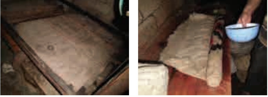
Şekil 3. Keçe tepme makinesinde tepme işleminin yapılışı ve birinci tepmeden çıkan keçenin sabunlu suyla ıslatılması.
