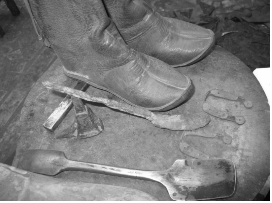
Resim 10: Maraş'ta 200 yıl önce yapılan bir edik ve çeşitli alet edevatla karlı havalarda kaymayı önlemek için ediğin altına çakılan nalçalar.
